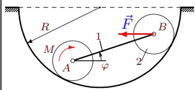
Оси цилиндров одинакового радиуса  $r$  соединены стержнем  $AB = 3r\sqrt{2}$  массой  $m_1$ . Цилиндры катятся по поверхности радиуса  $R = 4r$ . Масса цилиндра  $B$  равна  $m_2$ . К оси  $B$  приложена горизонтальная сила  $F$ , к цилиндру  $A$  — момент  $M$ . Составить уравнение движения системы. За обобщенную координату принять угол поворота стержня  $\varphi$ .
