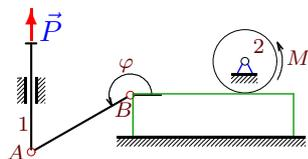
Стержень  $AB = a$  соединяет вертикальный поршень массой  $m_1$  и горизонтально движущийся брусок. Брусок вращает цилиндр радиуса  $R$  массой  $m_2$ . К цилиндру приложен момент  $M$ . Составить уравнение движения системы. За обобщенную координату принять  $\varphi$ .
