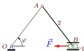
Механизм состоит из двух стержней одинаковой длины  $OA = AB = a$  и горизонтально движущегося ползуна  $B$  массой  $m_1$ . К ползуну приложена горизонтальная сила  $F$ . Масса стержня  $AB$  равна  $m_2$ , массой стержня  $OA$  пренебречь. Составить уравнение движения системы. За обобщенную координату принять  $\varphi$ .
