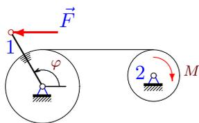
Цилиндр радиуса  $R$  жестко соединен с однородным стержнем массой  $m_1$  длиной  $a$ . Цилиндр вращается вокруг неподвижной оси и нитью связан с диском массой  $m_2$  радиуса  $r$ . Составить уравнение движения системы. За обобщенную координату принять  $\varphi$ .
